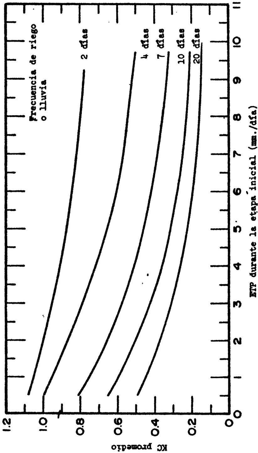
Figura 13 - KC Promedio para la Etapa Inicial como una Función del Nivel de ETP (Durante la etapa inicial) y Frecuencia de Riego o de Lluvia Significativa).
