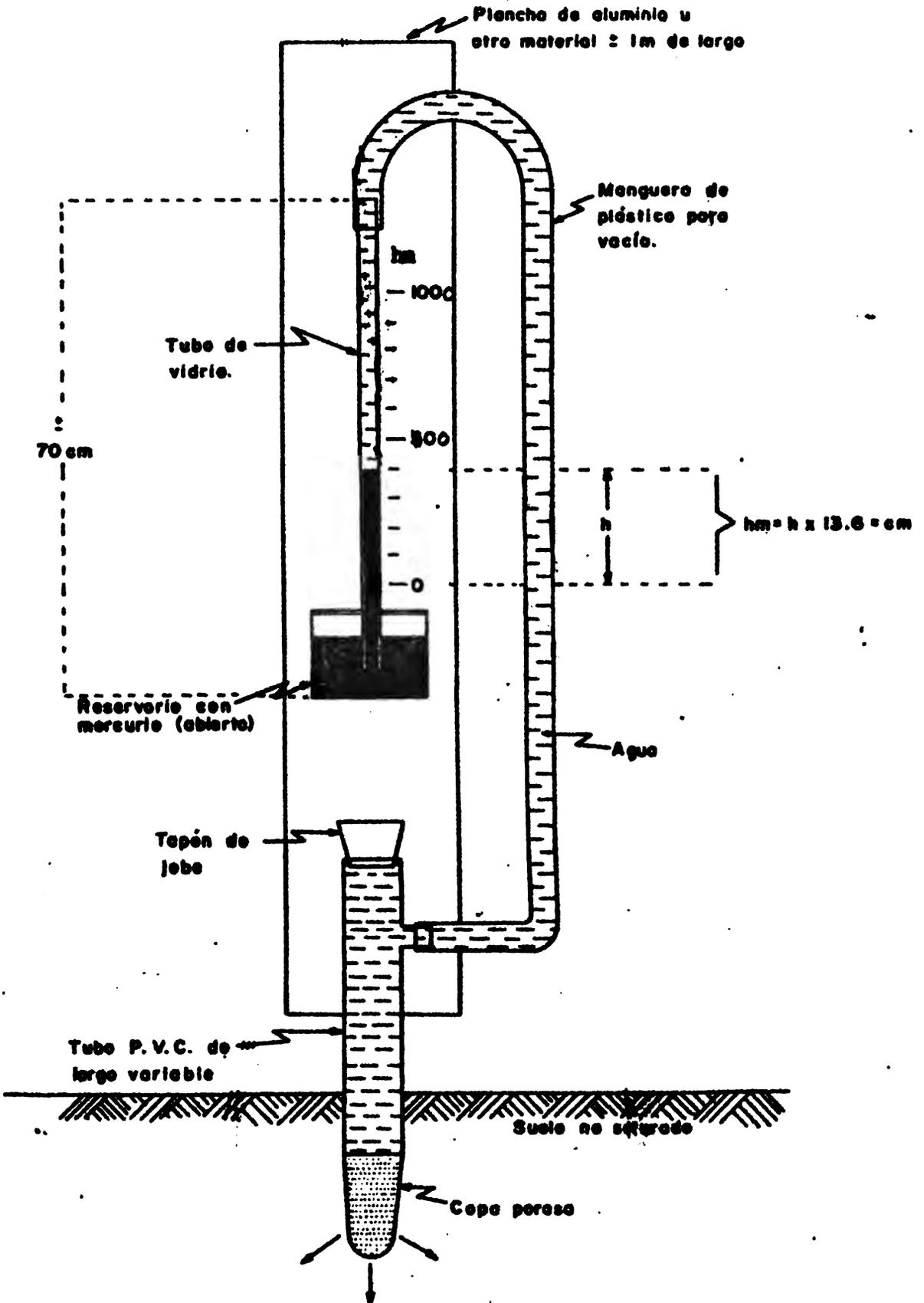
Figura 5 Esquema de un Tensiómetro sencillo.
