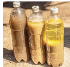
► Ejemplo de aplicación de cal al aguamiel, Beneficio San Rafael, propiedad de Los Naranjos Café, Cordillera Apaneca Ilamatepec. Foto: CSC
