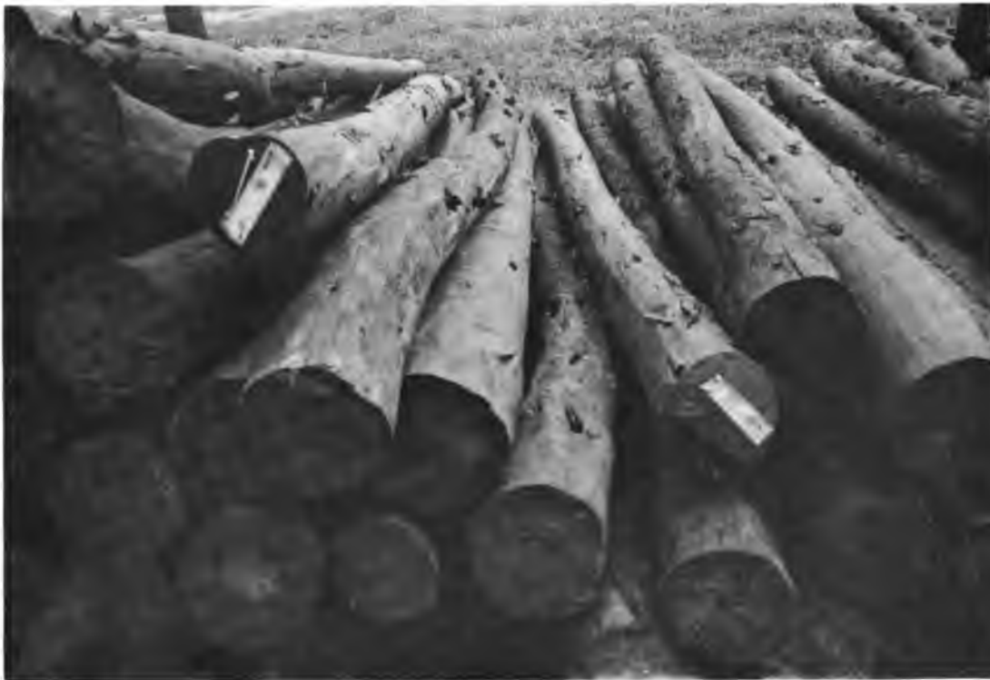
Postes para cerca de Pinus caribaea listos para ser tratados con pentaclofenol.
