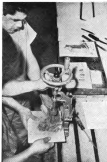
FIGURA 41. —Estudiando y obteniendo muestras de carne para la determinación de su dureza y extracto etéreo.
