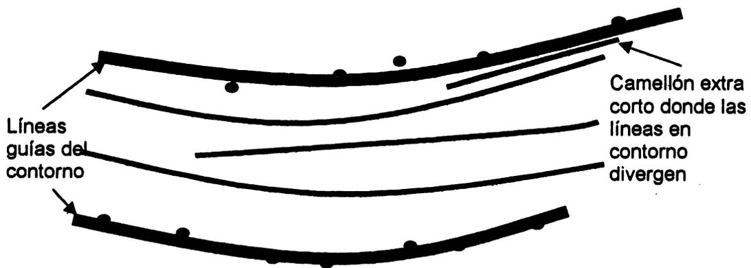
Figura 17. Camellones en contorno: técnica de trazado.
