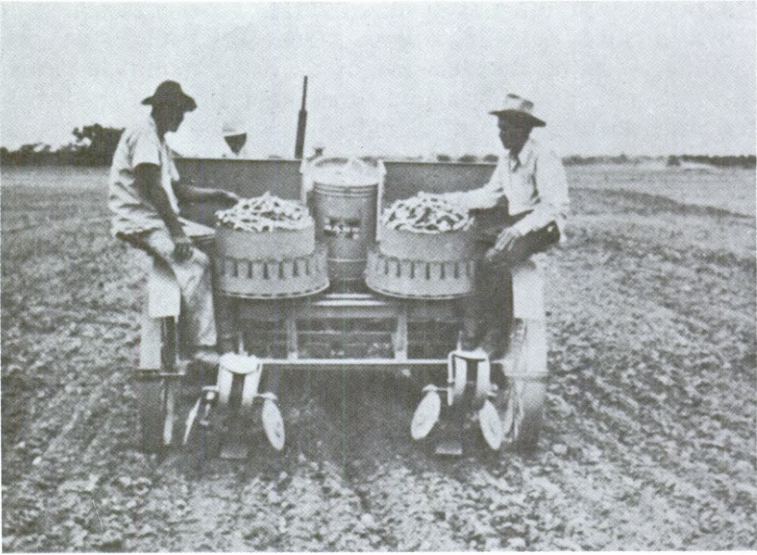
Fig. 27. Plantadora abonadora de yuca de dos hileras. Esta máquina requiere un tamaño uniforme de estacas de 12-15 cm y un reabastecimiento continuo tanto de estacas como de fertilizante. Este en lo posible debe ser granulado.
