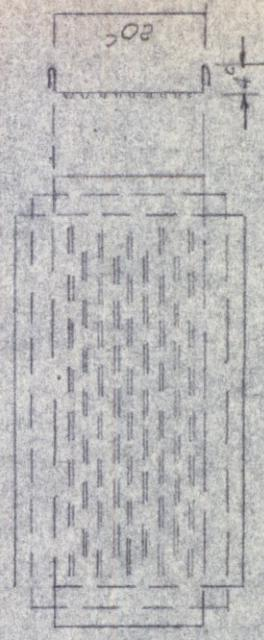
DETALLE DE LOS CONDUCTOS DE VENTILACION CUBIERTA METALICA DE LOS CONDUCTOS
