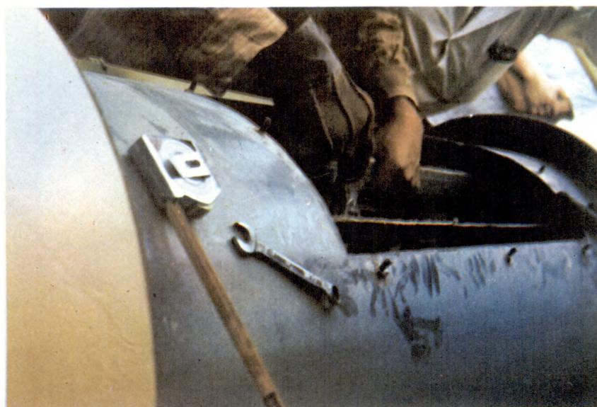
Fig. 5. Detalle del cilindro y las paletas escarificadoras con ajuste variable para la experimentación.
