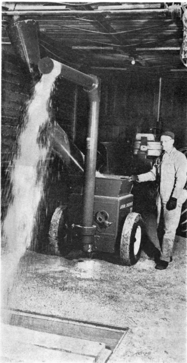
Fig. 1.7. Maíz desgranado proveniente de un almacén elevado es quebrado por un molino portátil de rodillos y transportado con un tornillo al pozo de un elevador. (Cortesía de Deer & Co., Moline, Ill.).
