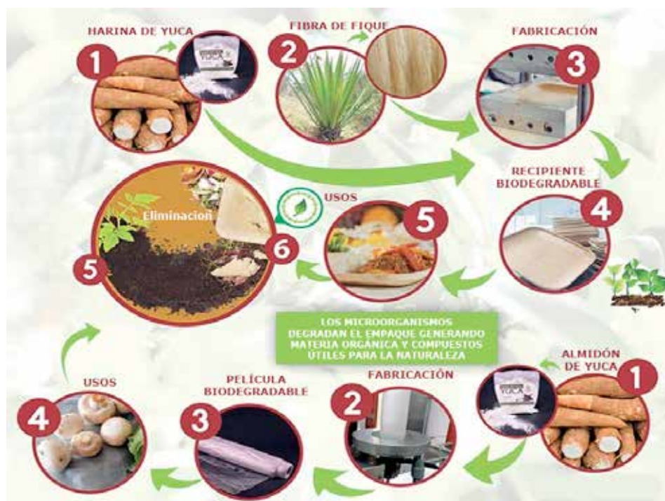
FIGURA 52. PROCESO DE ELABORACIÓN DE PELÍCULAS FLEXIBLES Y BANDEJAS SEMIRRÍGIDAS.
