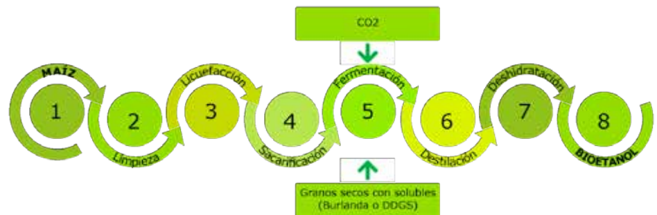
FIGURA 48. ESQUEMA SIMPLIFICADO DE LA PRODUCCIÓN DE BIOETANOL DE MAÍZ.
