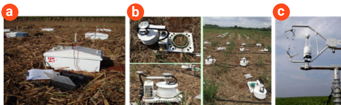
Figura 4. Metodologias utilizadas para amostragem de gases de efeito estufa emitidos do solo em campo. a) câmaras estáticas; b) câmaras dinâmicas, c) torre de covariância de vórtices turbulentos. Fotos: Carlos E.P. Cerri
