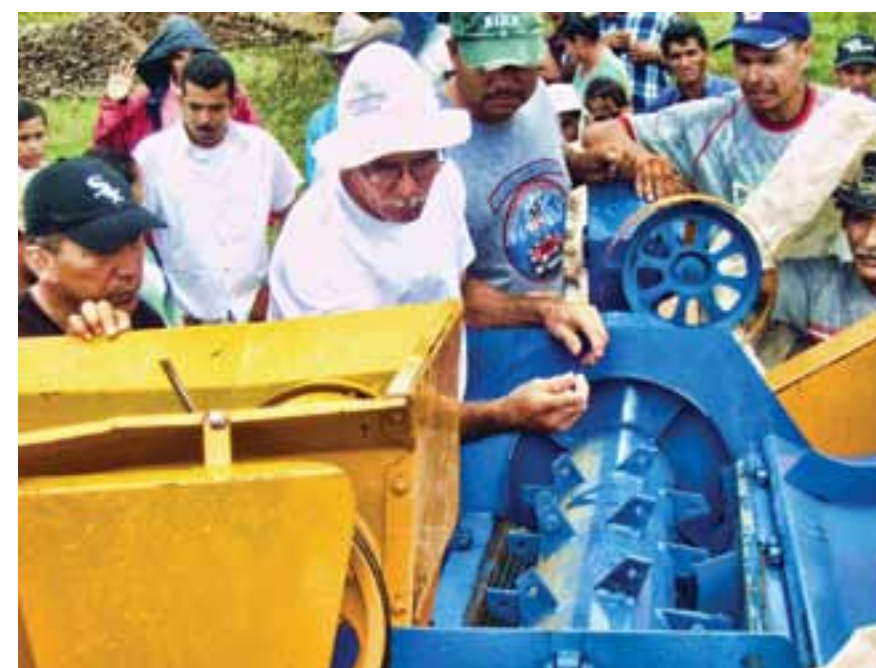
Figura 6. Proceso de ajustes a la máquina trilladora
