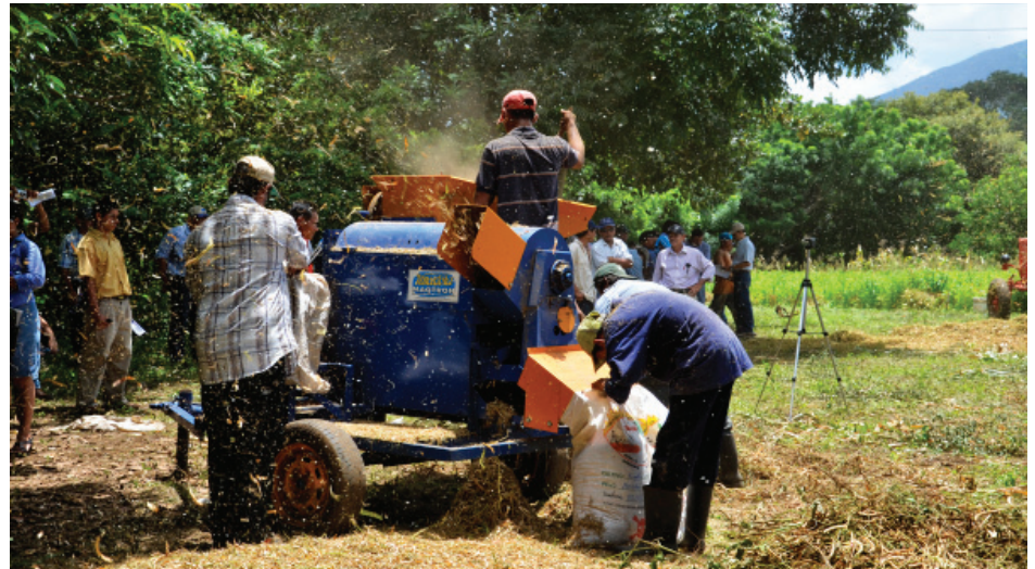
Ejercicio de trillado de frijol con una máquina modelo B-350 accionada por motor a gasolina.
