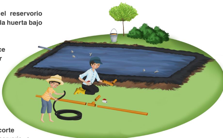
**6** Dependiendo de la orientación de las camas en la huerta, puede utilizar un codo o una “T” de 1 pulgada para poder instalar el tubo el otro tubo de 1 pulgada.
