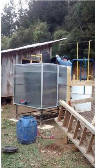
Nota: Ayuda a mantener por varios meses la inercia térmica del reactor en zonas de alta humedad y baja radiación solar.
