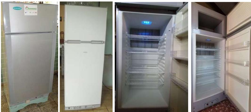
Los refrigeradores tienen dos compartimentos: uno de refrigeración y otro de congelación, con un volumen de entre 185 y 200 l y de entre 45 y 50 l, respectivamente. La presión del biogás requerida en el quemador debe ser de entre 25 y 30 mbar, con un consumo que va desde 1 a 1.5 m<sup>3</sup> de biogás/día, en función del equipo y las necesidades de conservación de alimentos de la vivienda.
