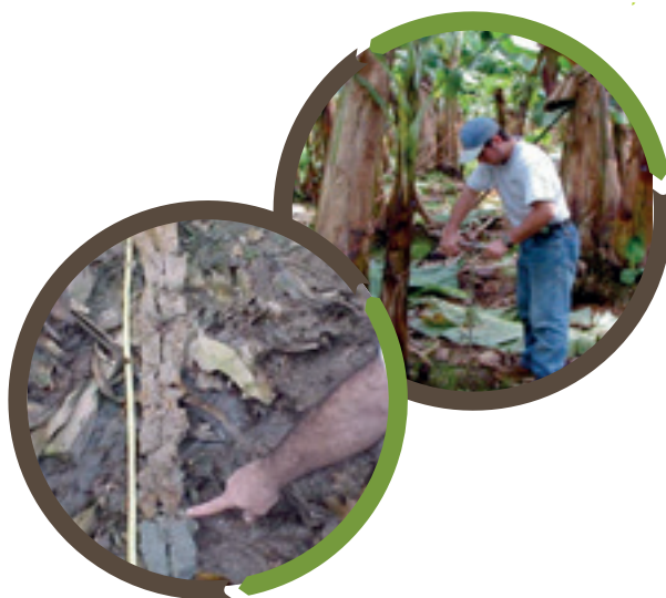
Figura 10. Muestreo de suelos, utilizando barreno y exponiendo las capas del perfil de suelo. Fuente: CORBANA.
