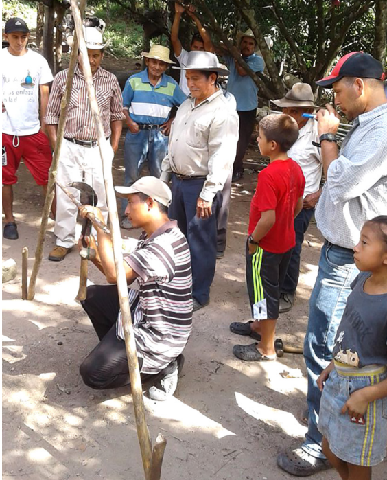
Foto 2. La plomada debe quedar debajo del travesaño.
