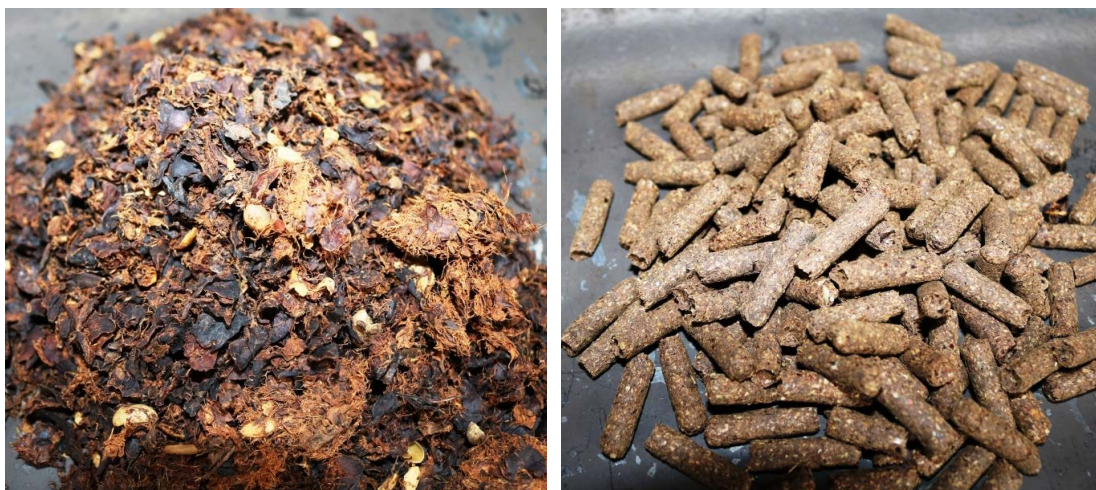
FIGURA 16. Pulpa pergamino elaborada como pellets listos para su combustión.
