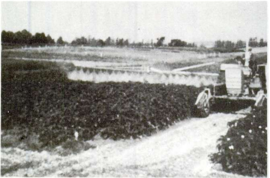
Fig. 64. Aspersión de fungicidas contra el tizón. Obsérvese el gran número de hileras que cubre la máquina y los callejones especiales para el paso del tractor.
