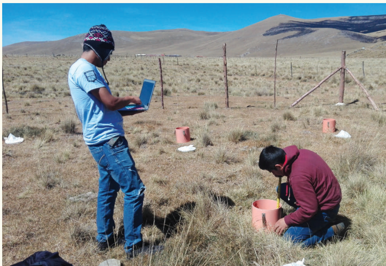
Medición de altura de cámara previo al inicio de colección de muestras de gas para la determinación de óxido nítrico en pastizales. Cooperativa Agraria San Francisco de Chichausiri, Junín (Perú)
