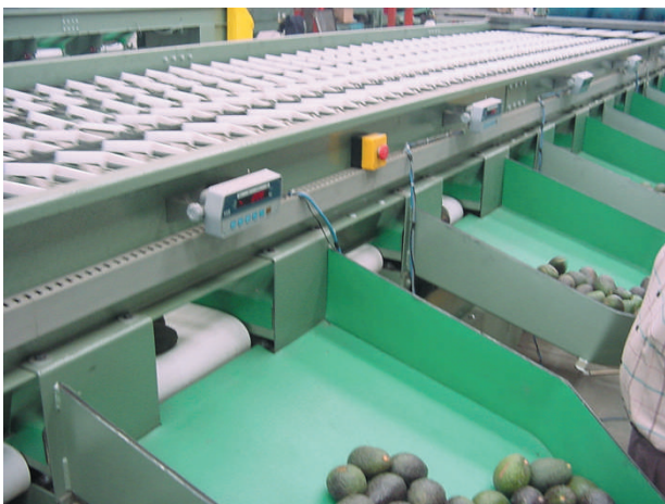
Máquina clasificadora y empacadora de aguacate, Michoacán, México.
