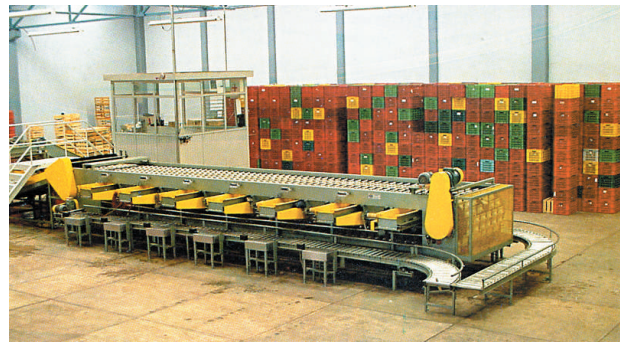
Máquina clasificadora computarizada de 6 líneas por 13 salidas, Uruapan, México.
