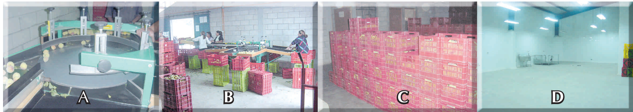
A) Máquina giratoria, separadora de tamaños; B) Jabas con producto; C) Palets o jabas agrupadas; D) Cuarto frío de almacenaje
