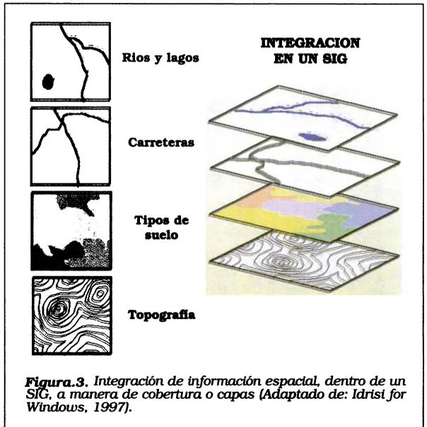
Figura.3. Integración de información espacial, dentro de un SIG, a manera de cobertura o capas (Adaptado de: Idrisi for Windows, 1997).
