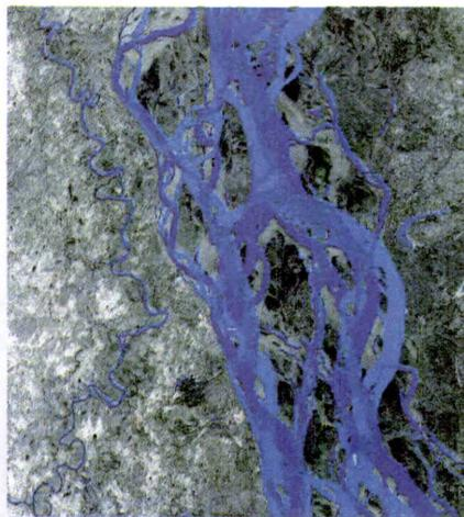
**Figura.8.** Imagen del SPOT que muestra cambios en el río Jamuna, brazo del Bramaputra, en Bangladesh, entre marzo de 1987 (azul oscuro) y marzo de 1989 (azul claro). El monitoreo del cambio en el comportamiento hidrológico del río permite modelar su curso y conducta, permitiendo llevar a cabo estudios preliminares para el control de inundaciones (SPOT, 1998).
