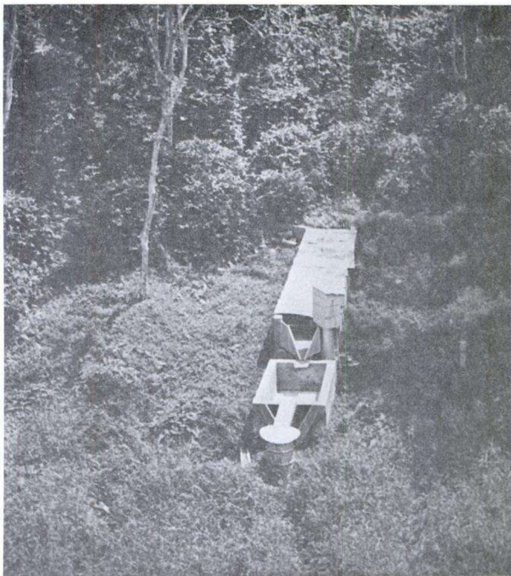
Fig. 144. Lote grande de escorrentía con su estación aforadora en la base. Este lote mide 6.000 m 2 y está sembrado de café.
