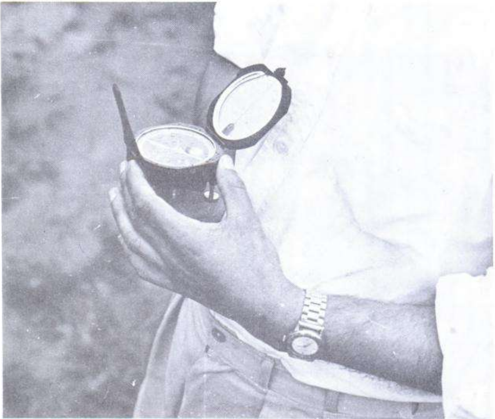
Fig. 33. Brújula. Los puntos se localizan mirando en el espejo de manera que la línea de lectura (en el centro del espejo), pase por la ranura de la pínula.
