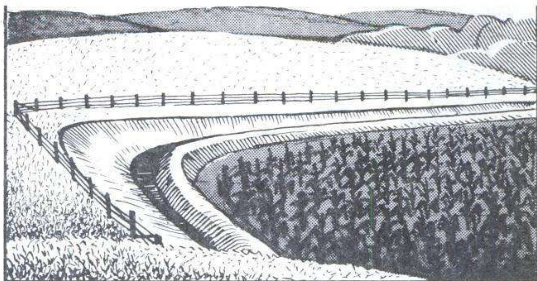
Fig. 84. Canal de desviación construido para proteger un lote bajo, sembrado con un cultivo limpio, de la escorrentía de un potrero.
