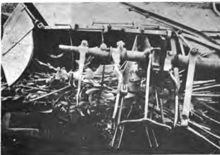
**Fig. 4. Vista del mecanismo atador de la máquina.**
