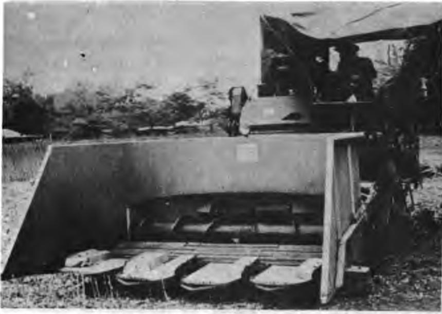
**Fig. 11. Vista del cabezal de corte.**
