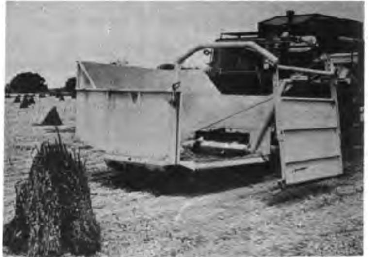
**Fig. 7. Vista del cabezal para el sistema Colaone.**
