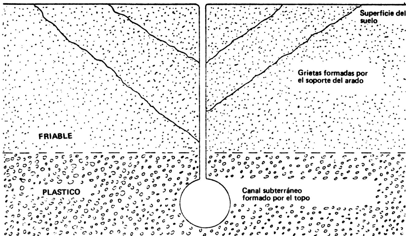
Figura 10. Formación de grietas por el arado de topo en la zona friable para acomodar infiltración del agua y drenes subterráneos en la zona plástica.
