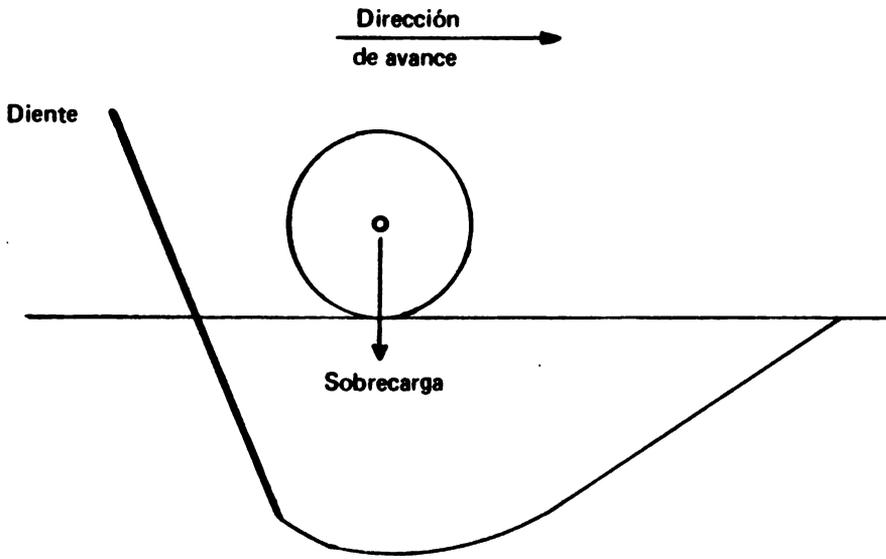
Figura 6. Manera en que la mala ubicación de una rueda de soporte de la herramienta sobrecarga la zona de falla del suelo y aumenta la fuerza de arrastre.
