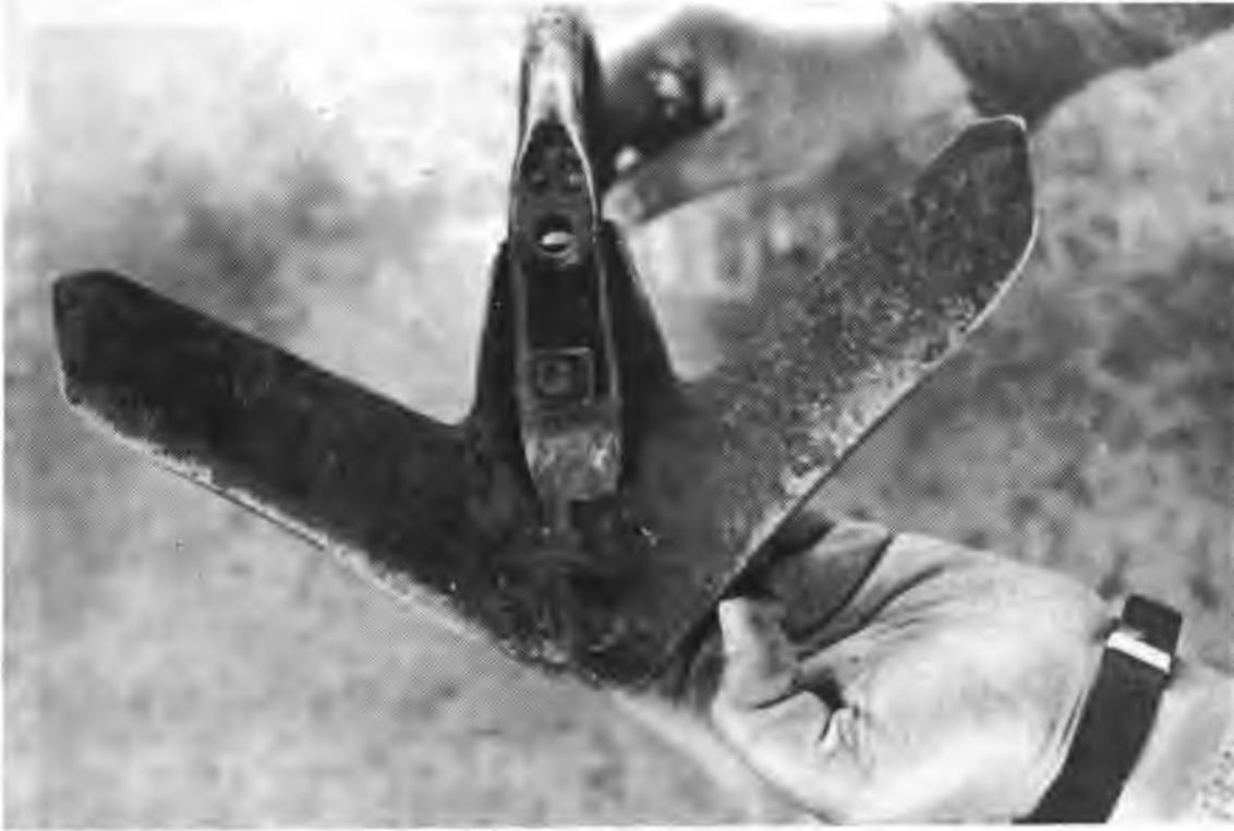
Figura 31. Ubicación de un escardillo en el orificio inferior del
