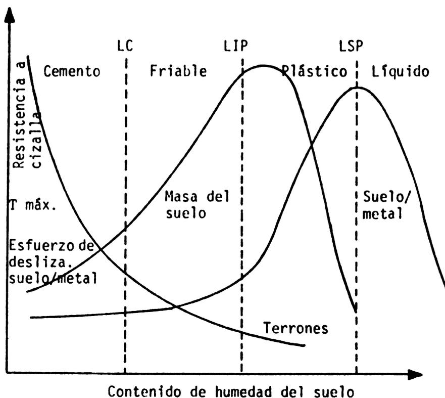
Figura 7. Resistencia a cizalla de los terrones y la masa del suelo como función de la humedad y el esfuerzo de deslizamiento suelo/metal.
