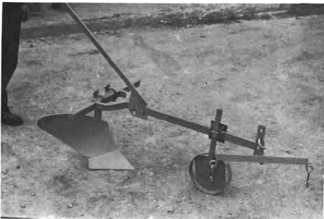
**Figura 9 - Arado de vertedera simple FAMA-E-INIA. Realiza un corte uniforme y a una profundidad adecuada.**
