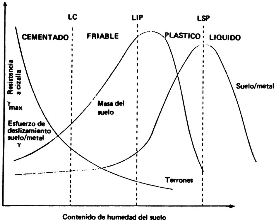
Figura 1. Relación del contenido de humedad del suelo con la resistencia de los terrones, la masa del suelo y al deslizamiento en el interfaz suelo/metal.
