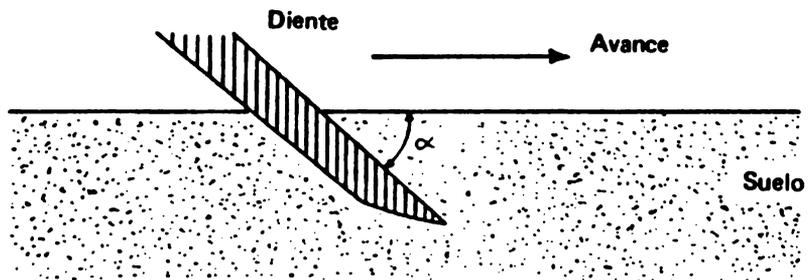
Figura 4. Efecto del ángulo de ataque ( $\alpha$ ) sobre la fuerza de arrastre ( $F_x$ ) de un diente.
