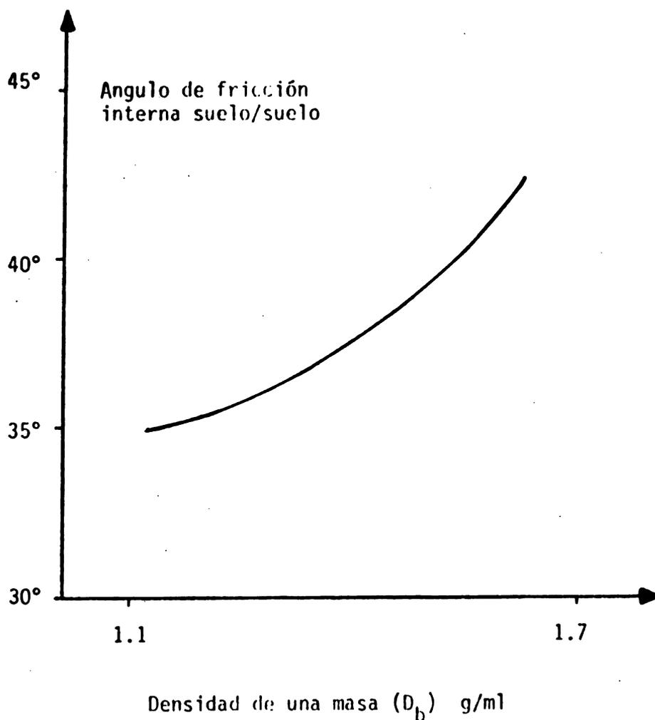
Figura 5. El ángulo de fricción interna de un suelo franco arenoso como función de su densidad en masa o su grado de compactación.
