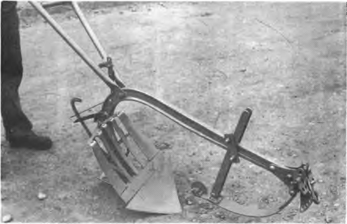
**Figura 13. Arado reversible alistonado FAMAE-INIA. Permite trabajar en suelos arcillosos plásticos disminuyendo el esfuerzo de adhesión.**
