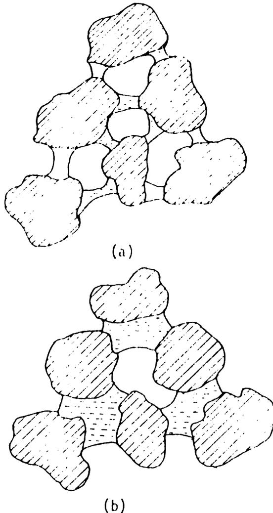
Figura 1. Atracción entre los terrones o agregados por la tensión superficial del agua. Esta ocasiona la cohesión superficial pero el número de interfases agua/aire disminuye con mayor humedad (b), asimismo el valor de la cohesión superficial.
