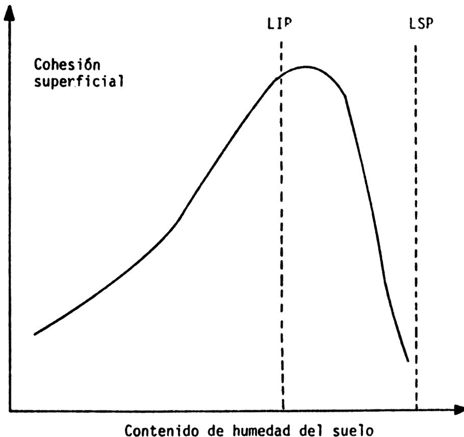
Figura 2. Efecto de la humedad sobre la cohesión superficial de un suelo.
