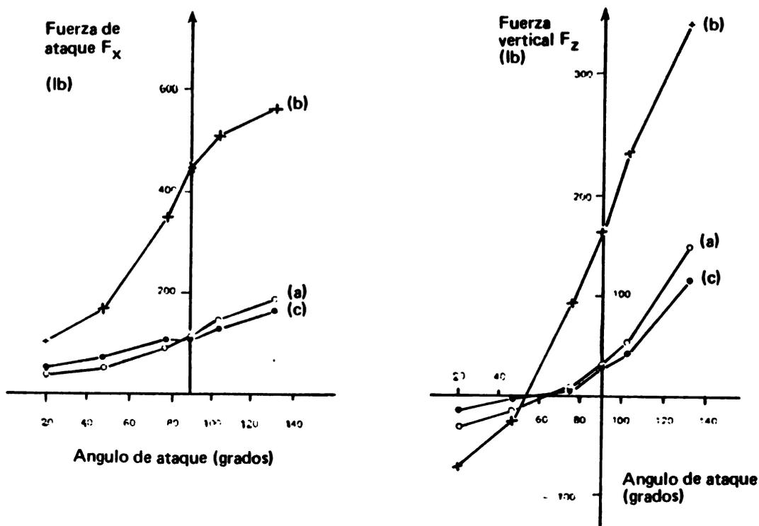
Figura 5. Relación del ángulo de ataque de un diente angosto con la fuerza de arrastre  $F_x$  y la fuerza vertical  $F_z$ ; a) arena con 3.8 por ciento de humedad; b) franco-arenoso con 9.4 por ciento de humedad; c) arcilla con 18.2 por ciento de humedad.
