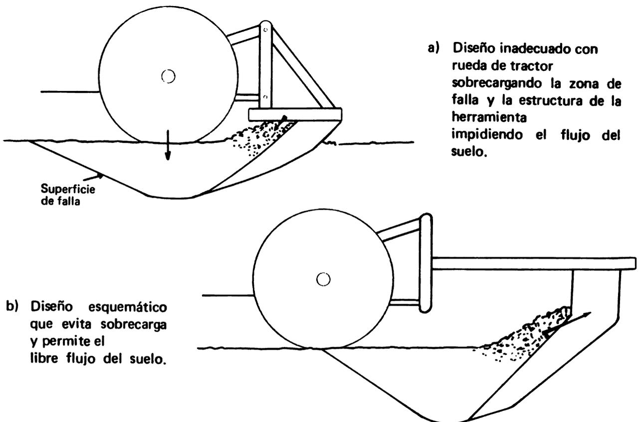
Figura 9. Manera en que el diseño de la herramienta puede afectar la fuerza de arrastre.
