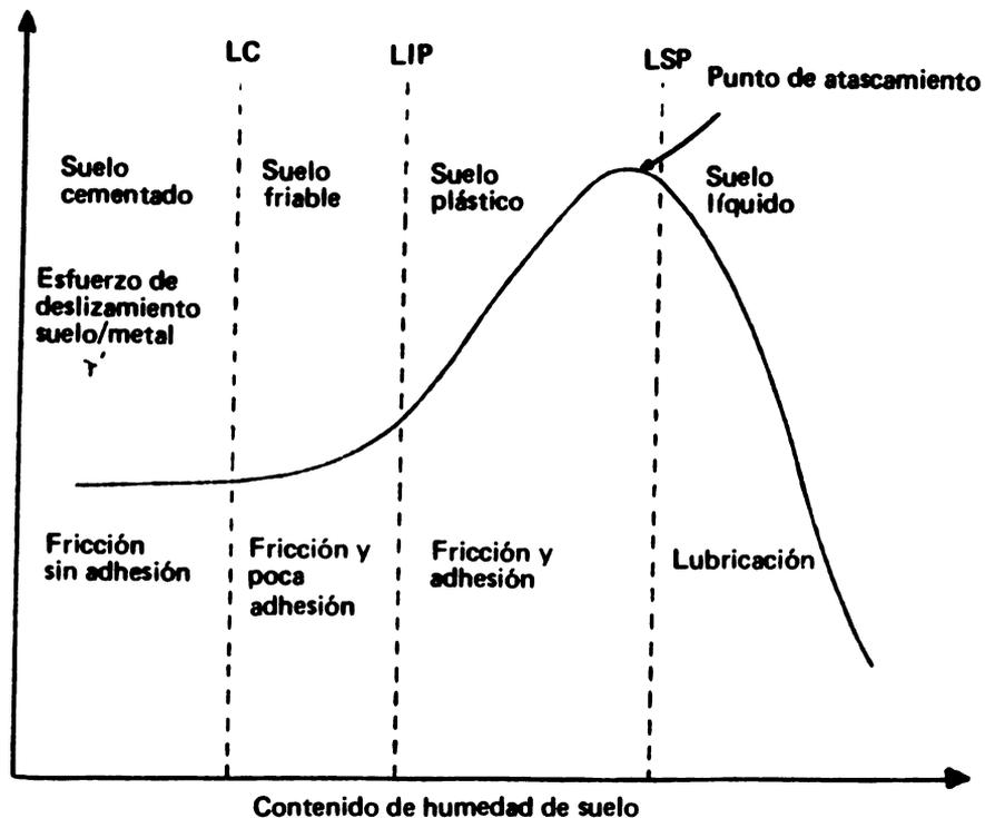
Figura 2. Efecto del contenido de humedad sobre el esfuerzo de deslizamiento suelo/metal.
