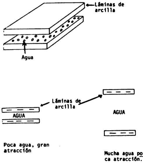
Figura 3. El agua entre las láminas o partículas de arcilla ejerce una atracción llamada cohesión molecular. Con poca agua, las partículas son atraídas fuertemente, pues la mayor humedad provoca distanciamiento y reducción en la fuerza de atracción.
