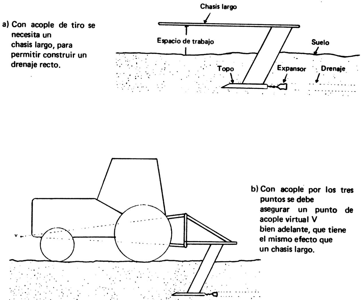
Figura 11. Diseño óptimo del arado de topo para acople de tiro o por los tres puntos del tractor.
