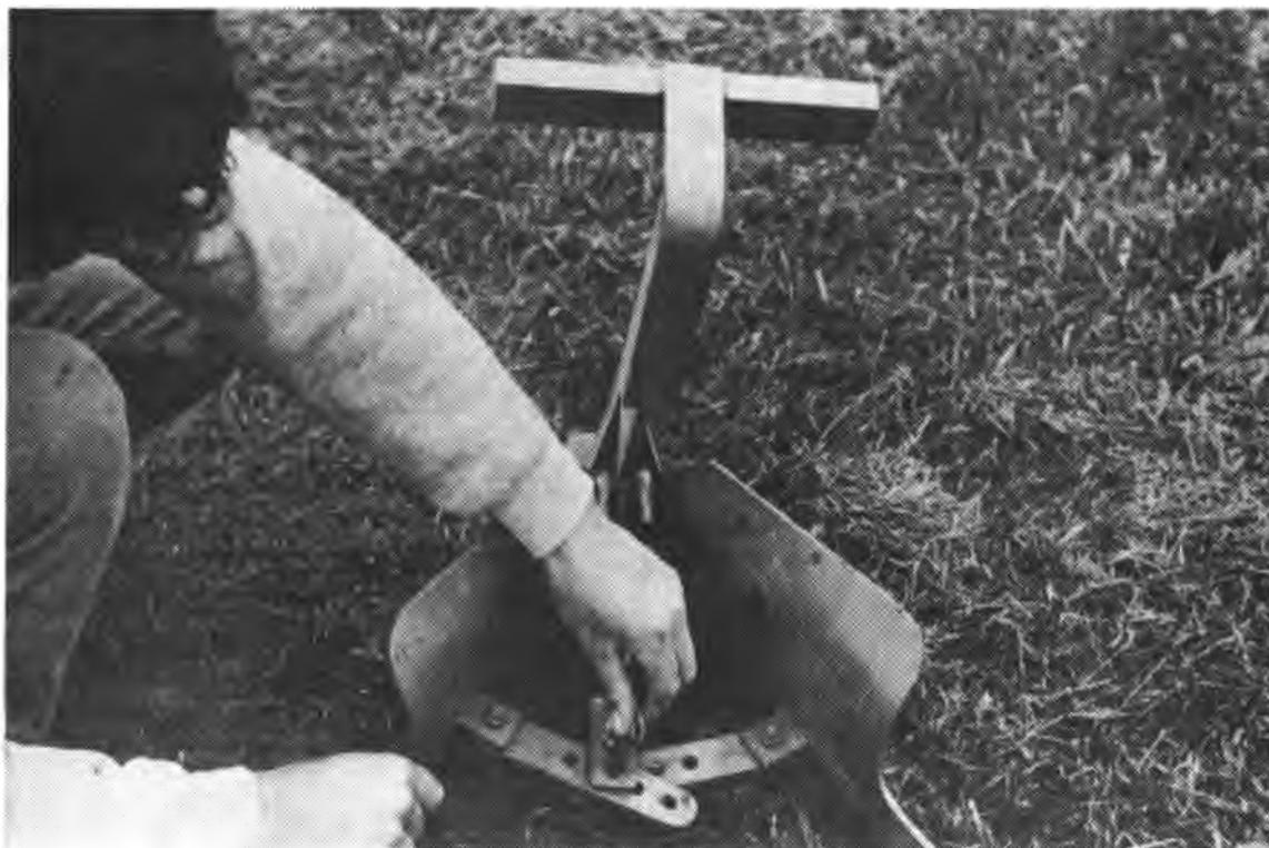
**Figura 26. Ajuste de trocha acequiador FAMAE-INIA.**
