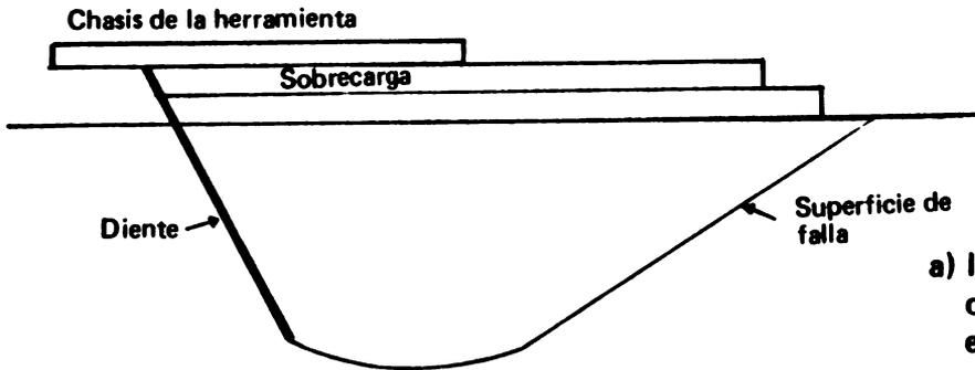
a) Interferencia de la estructura de la herramienta en el flujo de suelo.
