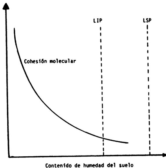
Figura 4. Efecto de la humedad sobre la cohesión molecular de un suelo.
