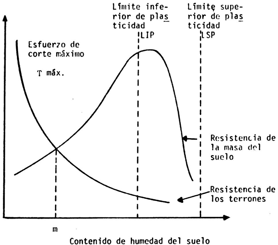
Figura 6. Resistencia en cizalla para la masa del suelo y los terrones individuales de acuerdo con la humedad del suelo.
