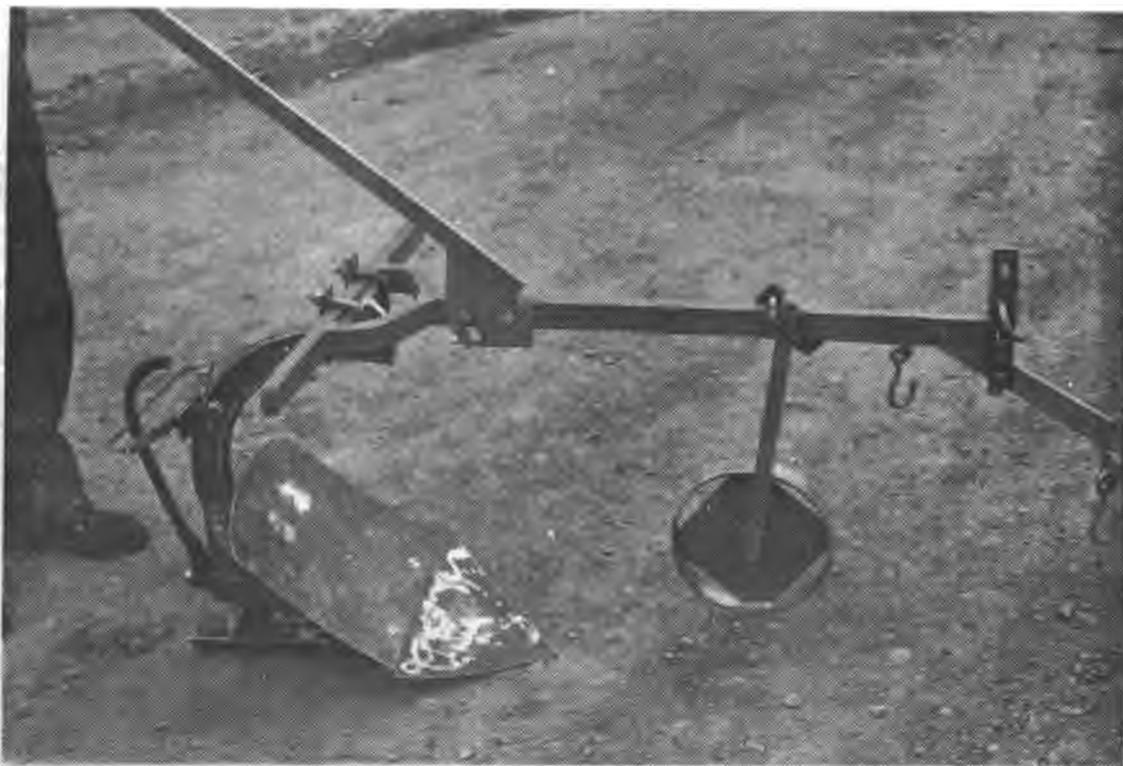
**Figura 12. Arado reversible FAMA E-INIA. Mejora la eficiencia de trabajo conservando el nivel del suelo.**
