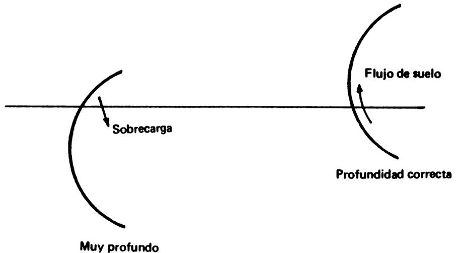
Figura 7. El diseño o uso inapropiado de las herramientas puede producir una sobrecarga innecesaria que aumenta la fuerza de arrastre.
