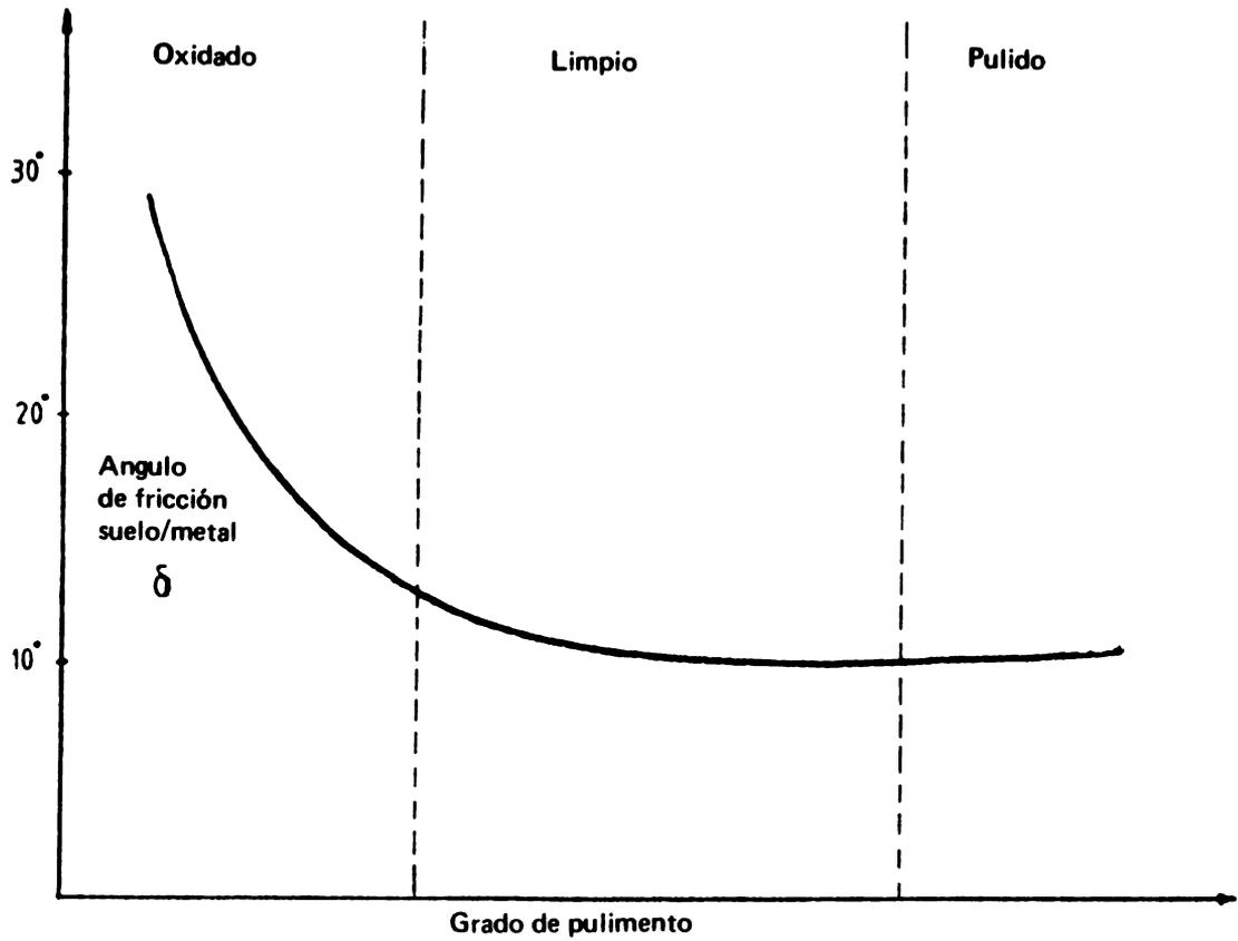
Figura 3. Efecto del pulimento de la superficie de contacto sobre el ángulo de fricción suelo/metal.
