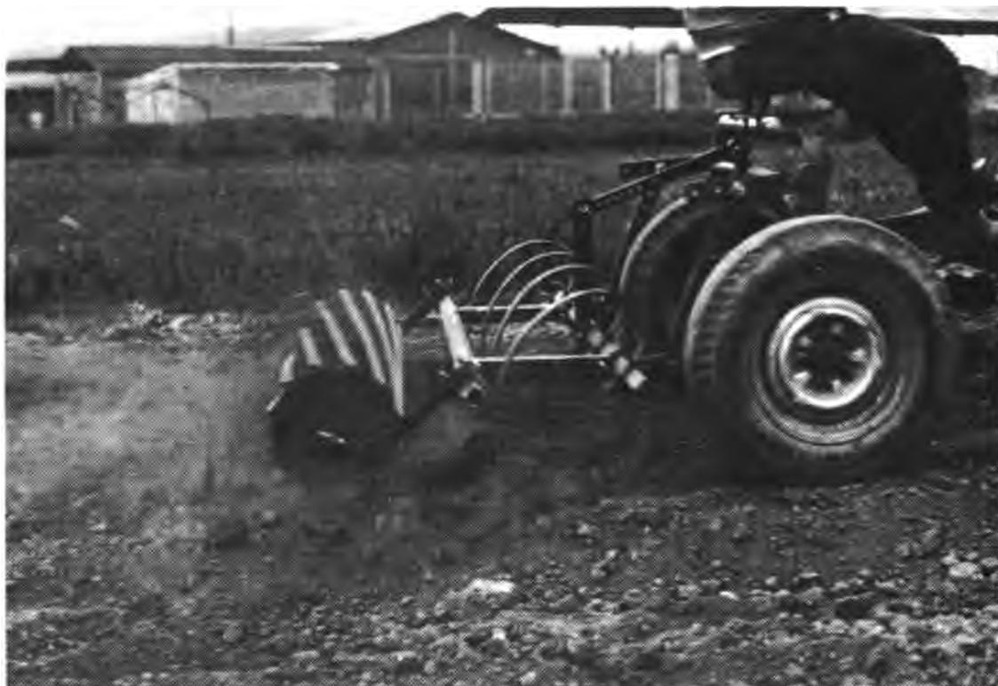
**Figura 17. Vibrocultor ICAT-INIA. Trabajo combinado de escarificadores con un rodillo tipo jaula.**
