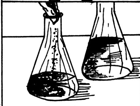
Se deja reposar la solución durante 10 a 15 minutos a temperatura ambiente, para que el agar pueda hincharse para disolver completamente los medios deben calentarse a más de 95°C.
