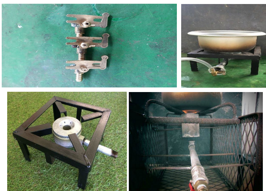
Ilustración 48. Adaptación de una estufa a través del 1) incremento del diámetro del orificio de inyección, 2) la conexión directa al quemador y 3) el mayor ingreso de aire secundario
