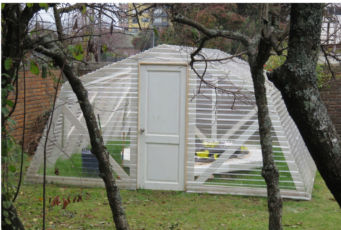
Ilustración 11. Prototipo de biodigestor educativo en invernadero para escuelas
