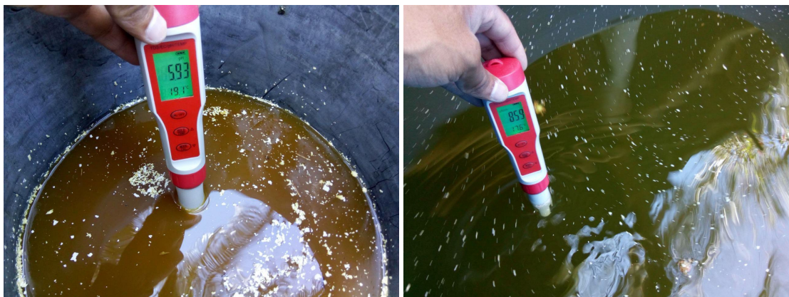
Ilustración 73. Medición de los parámetros de conductividad eléctrica y pH en los bioles
