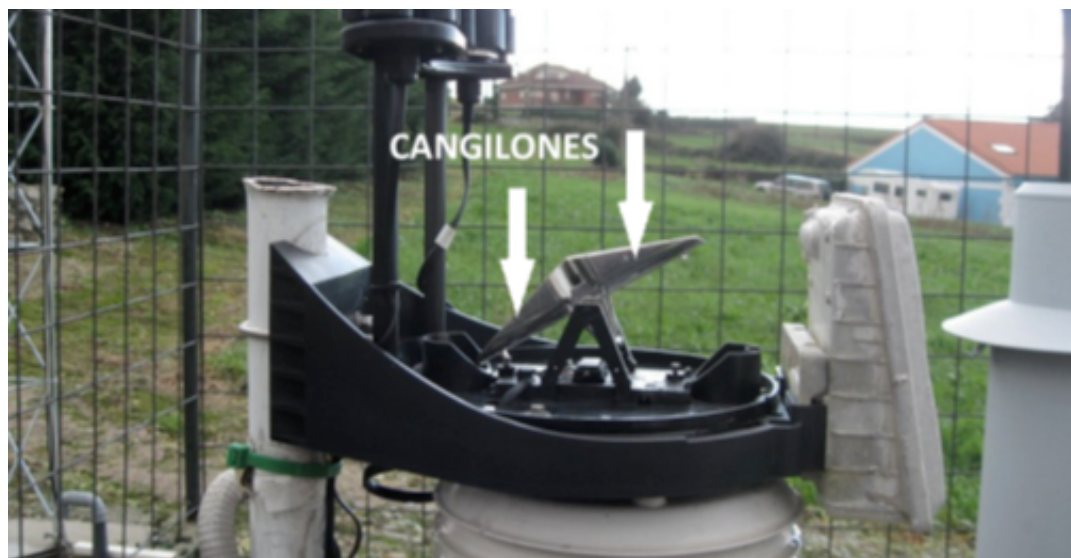
Figura 4: Interior de un pluviómetro automático de dos cangilones o cubetas basculantes.
